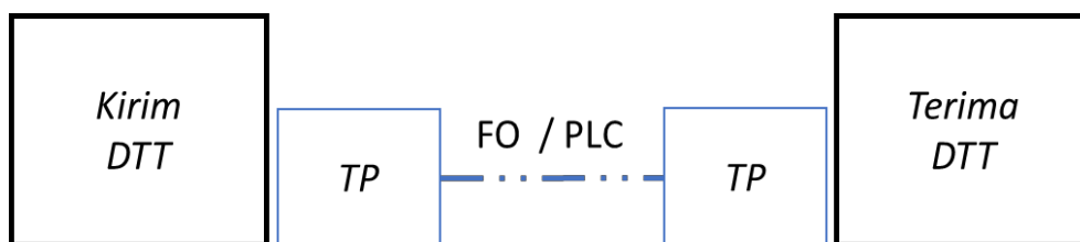
Gambar 9. Skema DTT 150 kV dan 20 kV
