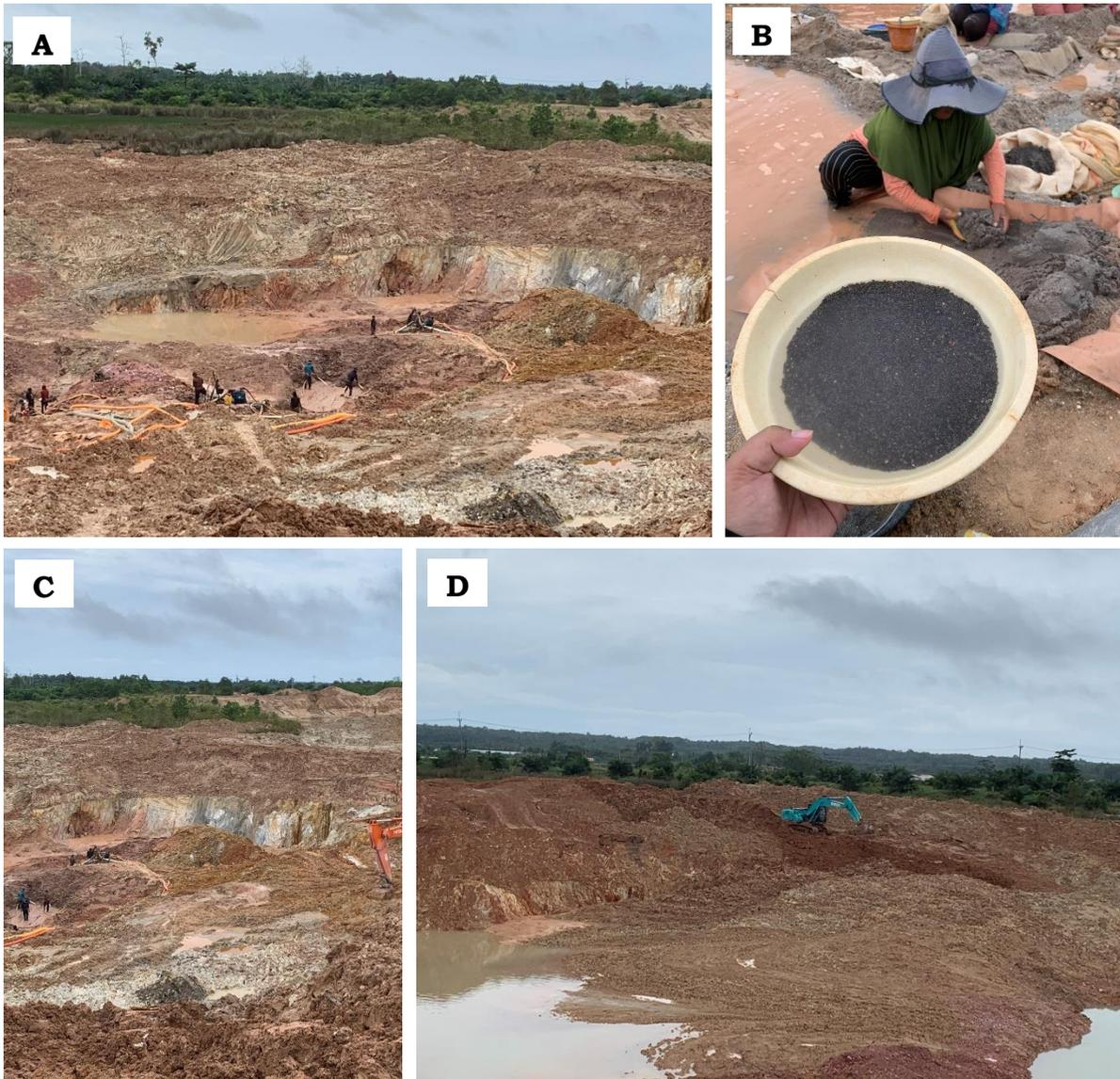
Gambar 26 A) Kegiatan semprot-sedot dilakukan 10-15 orang, cadangan timah pada lokasi WPR ini termasuk timah primer, B) Baskom hasil pendulangan timah yang berukuran halus, C) Aktifitas pengupasan overburden menggunakan excavator, D) Excavator selain digunakan untuk mengupas overburden juga digunakan ununtuk menata lubang-lubang bekas tambang
