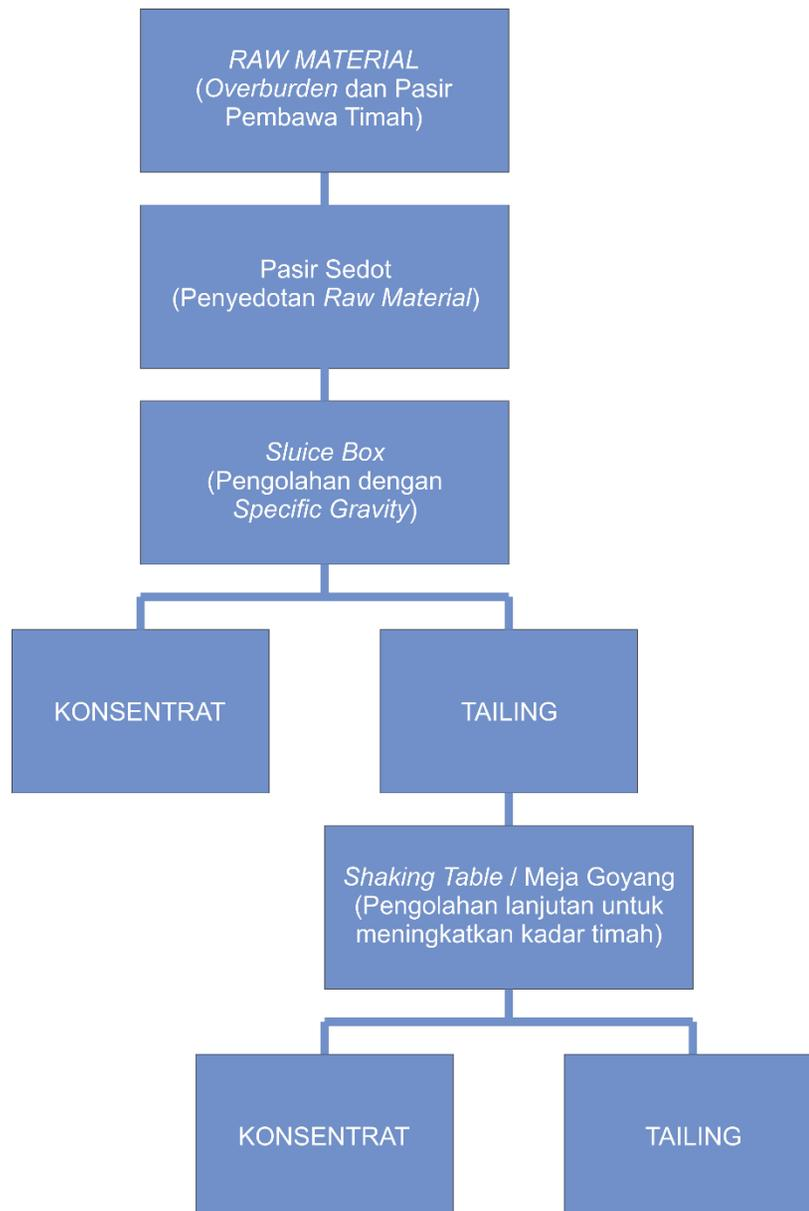
Gambar 15 Diagram alir alur penambangan dan pengolahan timah di Desa Malik dan Desa Paku Kecamatan Payung dan Desa Air Gegas Kecamatan Air Gegas Kabupaten Bangka Selatan
