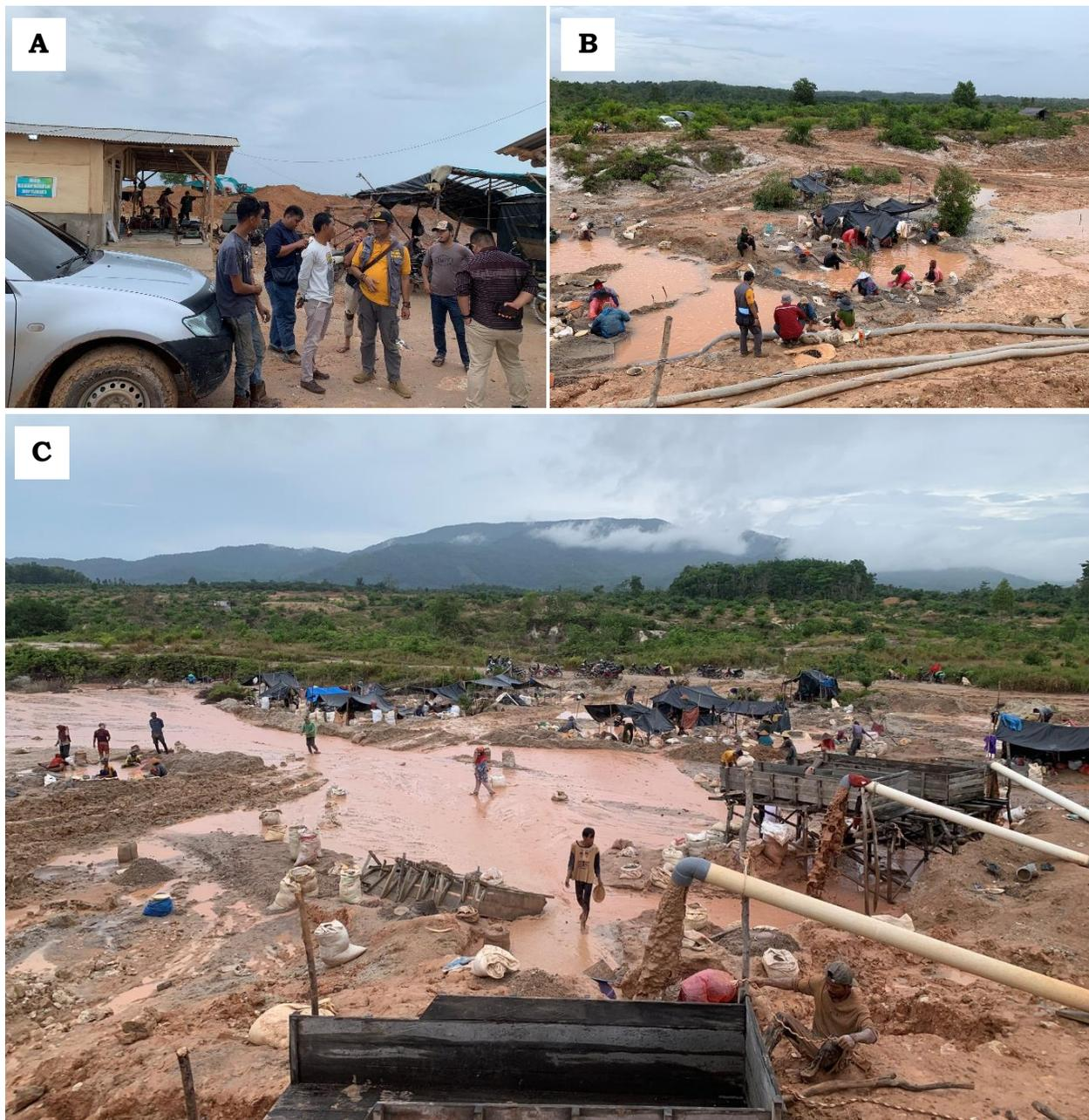
Gambar 25 A) Diskusi tim dengan penambang rakyat di area WPR, B) Para pendulang konsentrat timah yang berukuran halus, para pendulang ini adalah warga lokal dari sekitar area WPR, C) Pipa paralon 6 inci yang dialirkan menuju sluice box sederhana (sakan), nampak air buangan hasil sedot yang tergenang akan digunakan kembali untuk semprot (sirkulasi)
