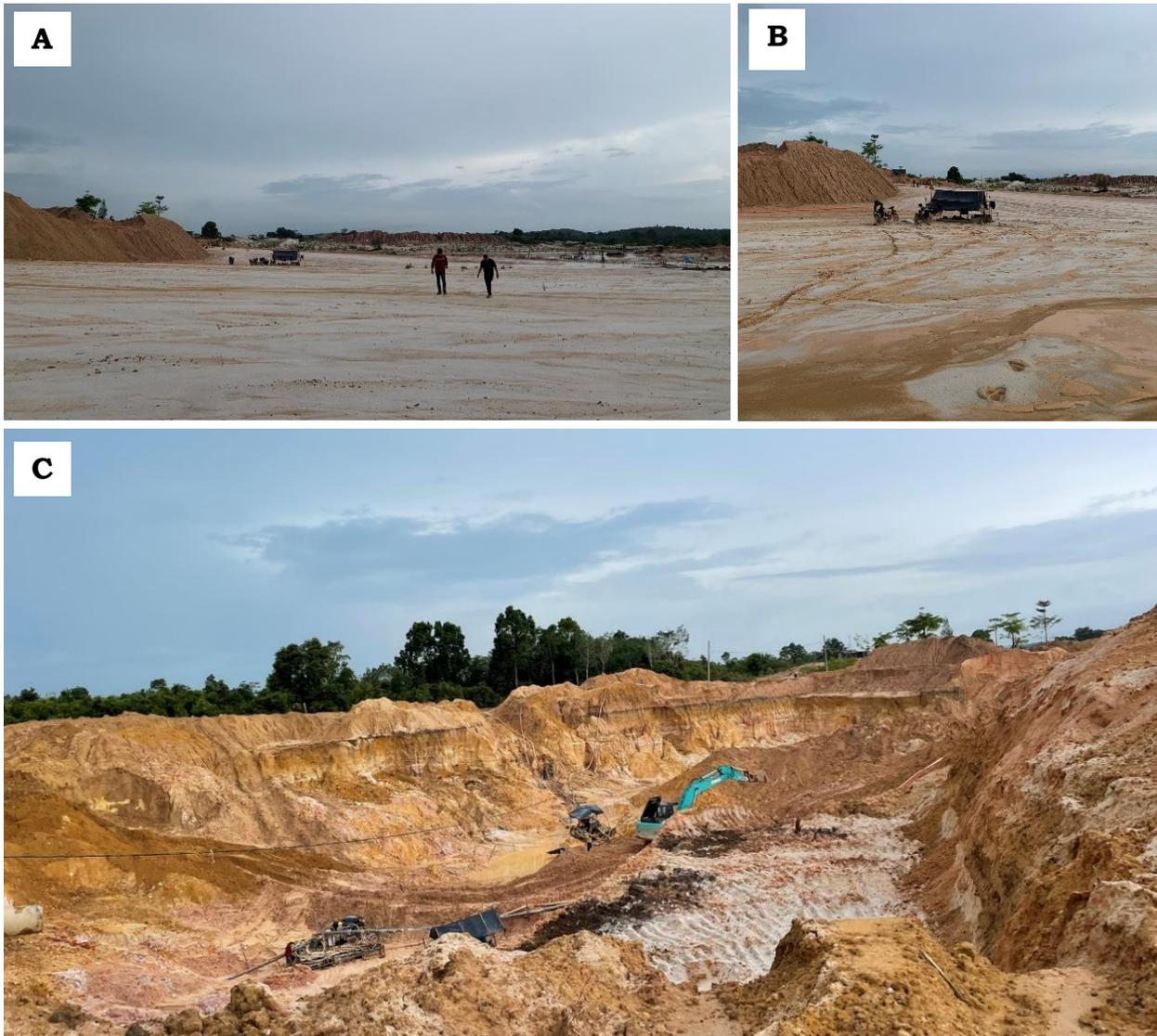
Gambar 23 A) Hambaran tailing dari ekstraksi timah dengan sluice box, B) Gubug kerja penambang rakyat, C) Excavator setara PC 200 yang digunakan untuk membongkar overburden dan nampak 3 set alat semprot-sedot lengkap dengan selang diameter 6 inci diatas ponton (drum yang disusun agar mesin semprot-sedot dapat mengapung)
