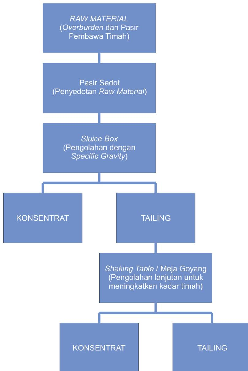
Gambar 27 Diagram alir alur penambangan dan pengolahan timah di Desa Perlang Kecamatan Lubuk Besar Kabupaten Bangka Tengah
