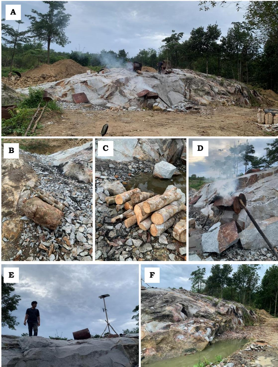
Gambar 34 A) Kegiatan penambangan granit yang sedang aktif, B) Granit yang dipecah kecil-kecil menjadi split, C) Kayu yang disiapkan untuk proses pembakaran, D) Proses pembakaran pada rekahan granit, E) Terdapat lampu penerangan untuk kegiatan penambangan di malam hari, F) Kondisi sekitar lokasi area WPR
