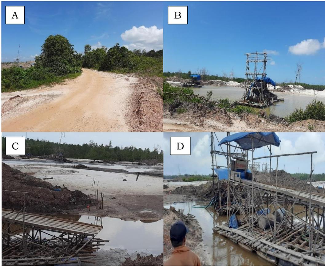
Gambar 26 A) Akses jalan menuju lokasi tambang B) Gubug kerja penambang timah rakyat di Desa Sukamandi , C) Hamparan tailing dari ekstraksi timah dengan sluice box, D) Set alat penambangan timah di lokasi WPR, nampak set alat semprot-sedot rig/tower lengkap dengan selangnya
