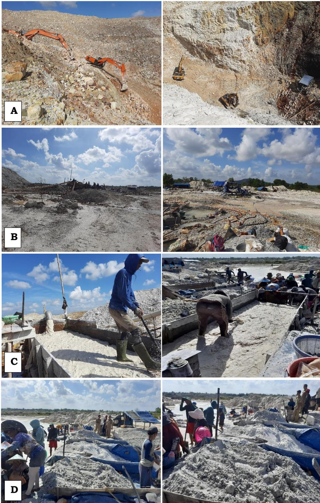
Gambar 22 A) Proses aktifitas penambangan timah di Desa Lenggang dengan menggunakan alat berat karena batuan yang masih keras, B) Pipa air untuk mengangkat material dari lokasi penambangan ke kotak gravity dan penampakan selang-selang air yang digunakan untuk menyalurkan kebutuhan air dalam proses pemisahannya, C) Proses pemisahan material yang sudah masuk ke dalam kotak gravity dengan alat sederhana/cangkul D) Hasil dari proses pemisahan penambangan timah di Desa Lenggang
