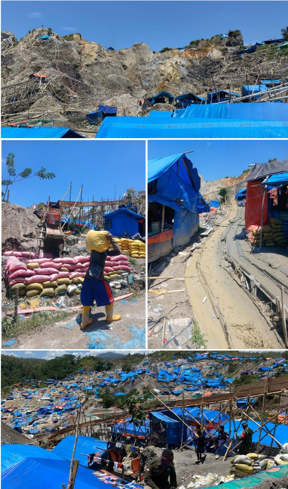
Gambar 9. Potret penambangan emas dengan metode mekanik dengan sepaket alat alat hidrolik-mekanik semprot sedot dan karpet di Gunung Botak, Desa Kaiely, Kecamatan Teluk Kaiely.
