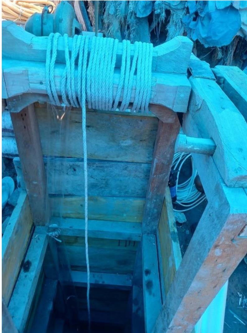
Gambar 10. Penambangan emas dengan metode terowongan vertikal yang dijumpai di Gunung Botak, Desa Kaiely, Kecamatan Teluk Kaiely. Ke depan, mekanisme IPR di Gunung Botak, pertambangan terowongan vertikal **TIDAK DIREKOMENDASIKAN.**
