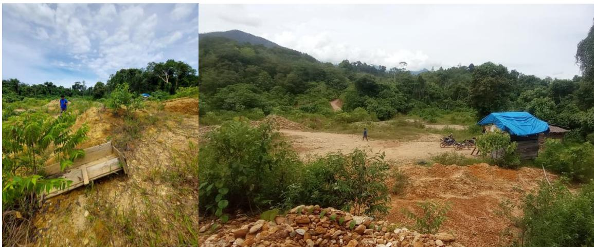
Gambar 19 Sluice box yang sudah rusak, gubug para penambang dan lubang bekas penambangan serta tumpukan material sisa yang dijumpai di pinggir Sungai Batang Gadis
