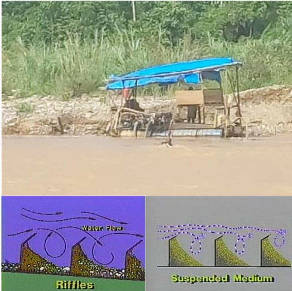
Gambar 22 Kolam pengendapan bijih yang sudah dipasang riffle untuk menahan bijih emas
