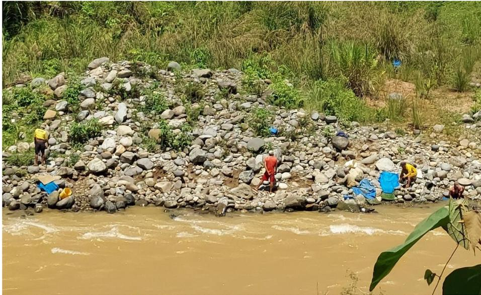
Gambar 17 Penambangan emas dengan metode tradisional dengan panning yang dijumpai di kotak WPR MDTL-03 di wilayah Kecamatan Batang Natal
